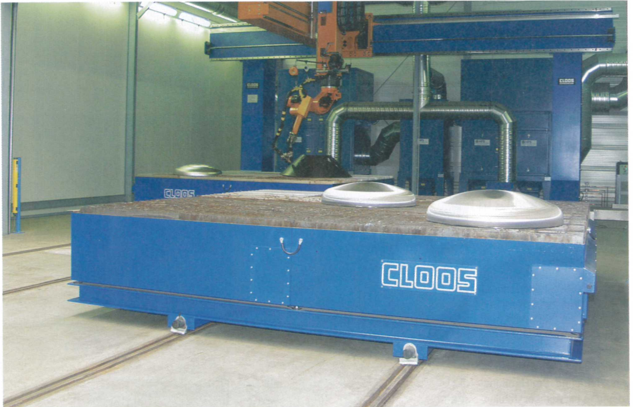
Die Plasma-Schneidanlage wird über zwei Brennschneidische von je 4m x 4m beschickt
